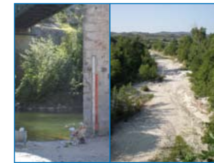
Suivi estival des niveaux d'eau et participation à la "cellule de gestion des étiages" auprès des services de l'Etat.
